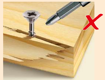
Vissage avec vis à bois aggloméré traditionnelle sans préperçage.
