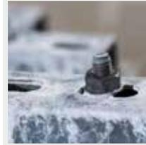
**GreenTec®** est un système d'alliage spécial reposant sur une base en zinc et en nickel offrant une couche solide résistant à l'usure et présentant une grande résistance à la corrosion même en présence d'une faible épaisseur de couche. Le système stratifié **GreenTec®** doté d'une excellente répartition du métal et d'une composition d'alliage constante dispose d'une large gamme de modes d'utilisation une fois le bon post-traitement effectué.
