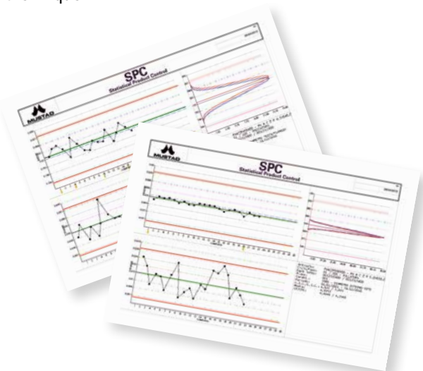
Variation de la dureté de la vis après traitement thermique.
